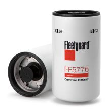
**Gasket Inside Diameter** 101.60 mm 118.87 mm **Gasket OD** Tamaño de rosca M90 X 2-7H INT Longitud 226.52 mm mayor diámetro exterior 119.89 mm 119.89 mm Seam OD **Standpipe** NO **EFFICIENCY, TWA BY SAE J 1985** 98.7% **MICRON RATING BY SAE J 1985** 5 micron
